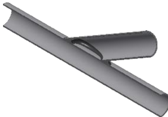
Figura B-38 – Corte para visualização da penetração da solda
