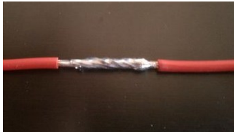
Figura B-18 – Emenda adequadamente soldada
