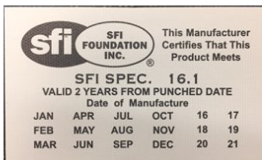
Figura B-44 – Modelos de etiqueta com data de fabricação (esq.) e data de validade (dir.) de cintos certificados na norma SFI 16.1
